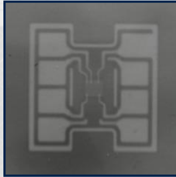
“Fernseher“-Röntgenbild zeigt Chip und Verbindungen
