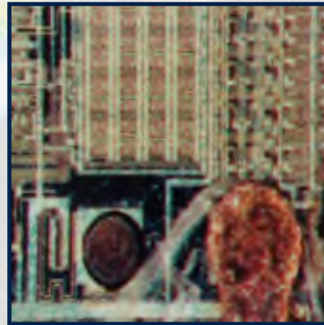
Eins der zusätzlichen Pads nach Öffnung des Chipmoduls
