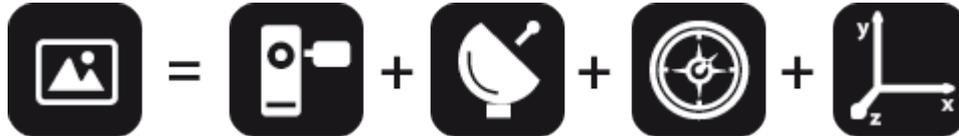
Abb. 2 – Zusammensetzung des Reality View aus Kamera, Satellitenortung, Kompass und Neigungssensor
